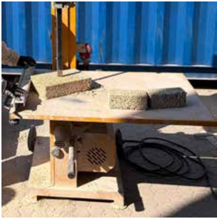
Corte del Biomattone® con sierra de cinta
