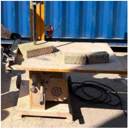
Schneiden des Biomattone® mit der Bandsäge
