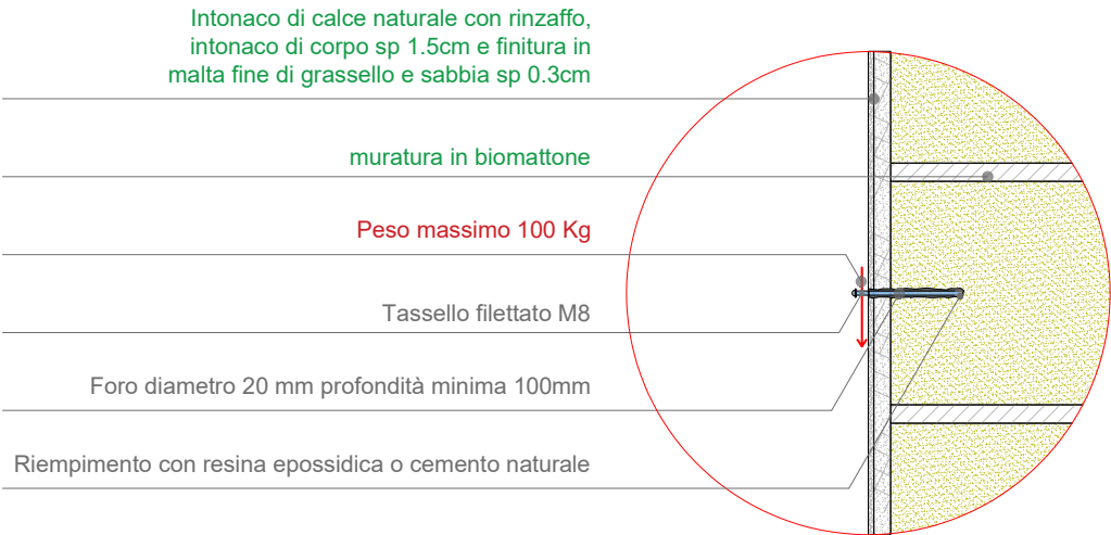
Detail Lastauflagerung hohe Lasten
