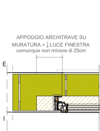
Sezione all'altezza dell'architrave
