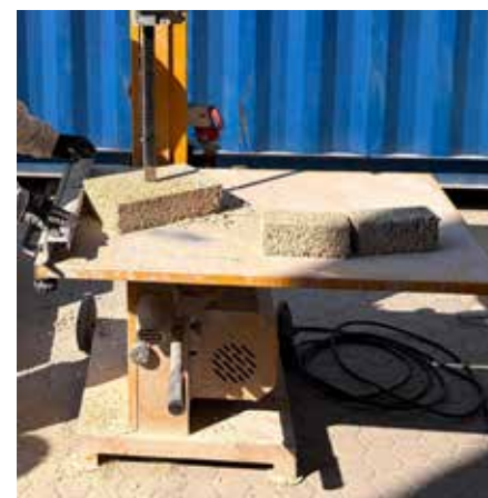
Taglio del Biomattone® con sega a nastro
