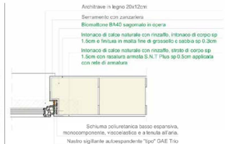
Sezione all'altezza del serramento
