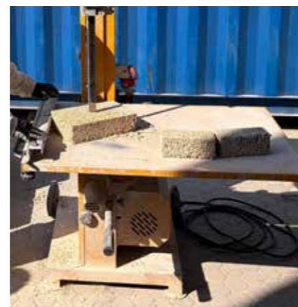
Taglio del Biomattone® con sega a nastro
