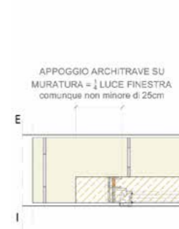
Sezione all'altezza dell'architrave
