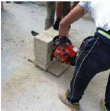
Corte del Biomattone® con sierra eléctrica de cadena
