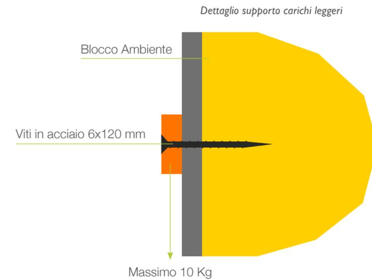
In caso di carichi elevati mediante fori di opportuna profondità (minimo 10cm) in cui inserire tasselli meccanici o barre filettate annegati in resina epossidica o cemento rapido.
